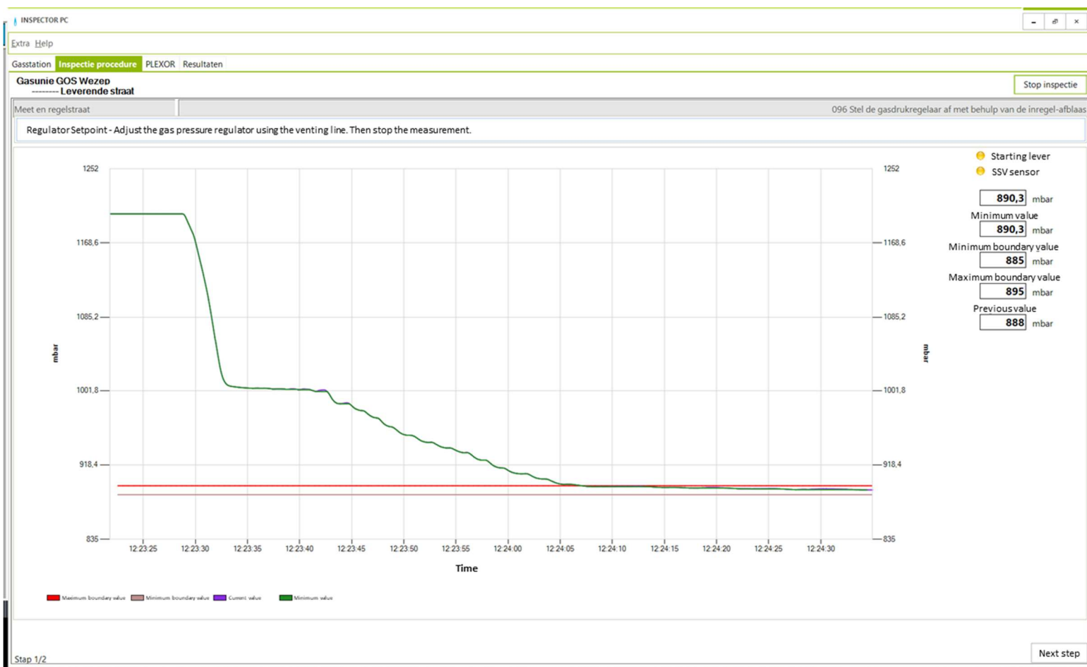
Bild 5: Umschaltung vom Monitorregler zum Hauptregler
